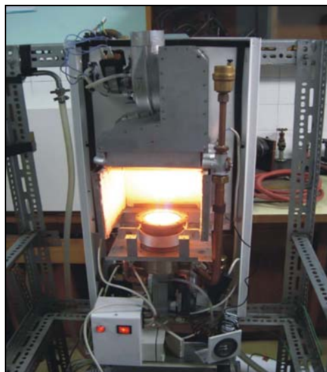
Slika 7. Izgled kotla sa ugrađenim gorionikom sa poroznom sredinom na probnom stolu
