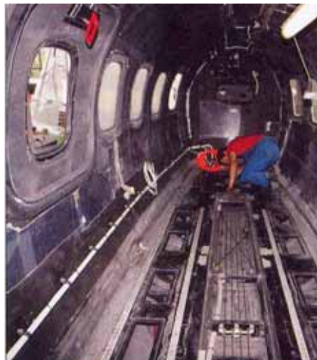
Slika 1.- Izgled unutrašnjosti kompozitnog trupa mlaznog aviona tokom izrade u firmi Grob, Švajcarska /10/
