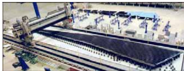
Slika 14. Flow obradni centar sa glavom za sečenje kompozita vodenim mlazom i abrazivom sa radnim stolom dužine 36 metara /5/
