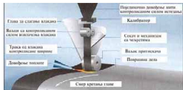
Slika 5. Automatizacija procesa slaganja kompozita povećava efikasnost u proizvodnji
