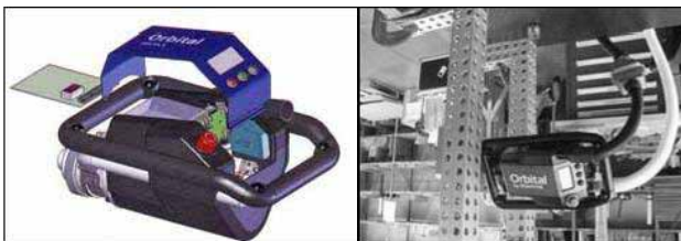
Slika 13. Izgled prenosnog sistema za orbitalno bušenje; bušenje rupa pri montaži
