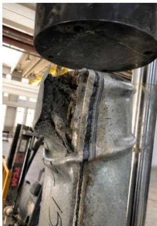
(d) Concrete Core Crushing
