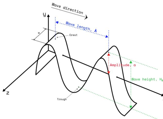
Fig. 2. Sinusoidal wave
