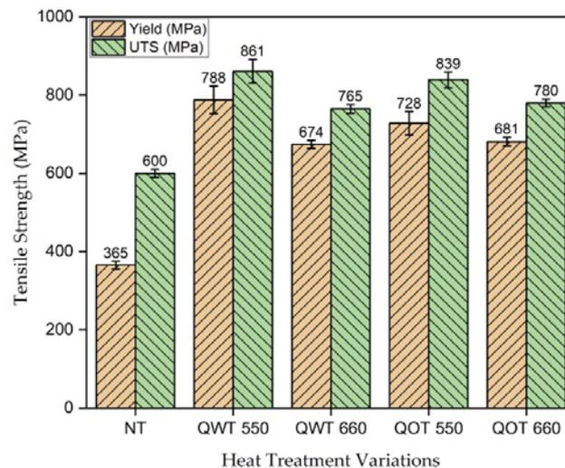
Fig. 4. Tensile test S45C
